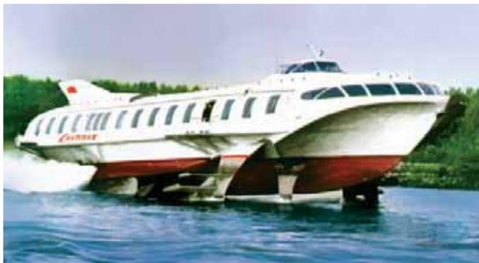
«Спутник»: водоизмещение – 110 т; пассажироместимость – 118 чел.; мощность ЭУ – 4×1200 л.с.; скорость хода – 65 км/ч; высота волны – 1.5 м; дальность хода – 800 км
