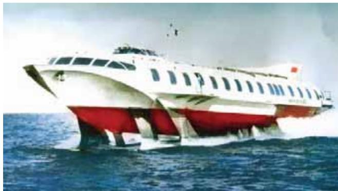
«Вихрь»: водоизмещение – 121.3 т; пассажироместимость – 260 чел.; экпл. мощность ЭУ – 4×1200 л.с.; экпл. скорость хода – 32 уз; мореходность – 2 балла
