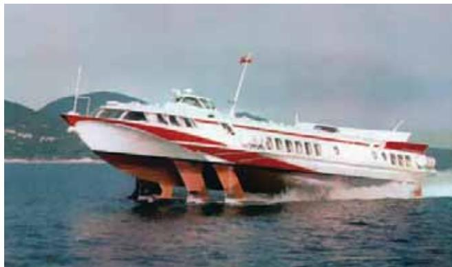
«Комета»: водоизмещение – 56 т; габариты – 35.2×11.0 м; пассажировместимость – 118 чел.; экпл. мощность ЭУ – 2×800 л.с.; экпл. скорость хода – 32 уз; мореходность – 4 балла; дальность хода – 250 миль
