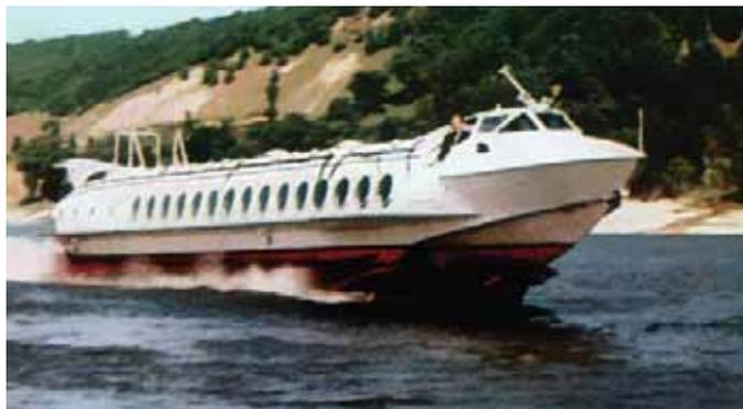
«Чайка»: водоизмещение – 14,3 т; габариты – 26,3×3,8×3,54 м; пассажироместность – 30 чел.; макс. мощность ЭУ – 1200 л.с.; макс. скорость хода – 100 км/ч; дальность хода – 400 км
