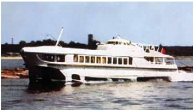
«Ракета»: водоизмещение – 22 т; габариты – 27.0×5.0×4.5 м; пассажироместность – 66 чел.; эксл. мощность ЭУ – 820 л.с.; скорость – 60 км/ч; высота волны – 0.6 м; дальность хода – 600 км
