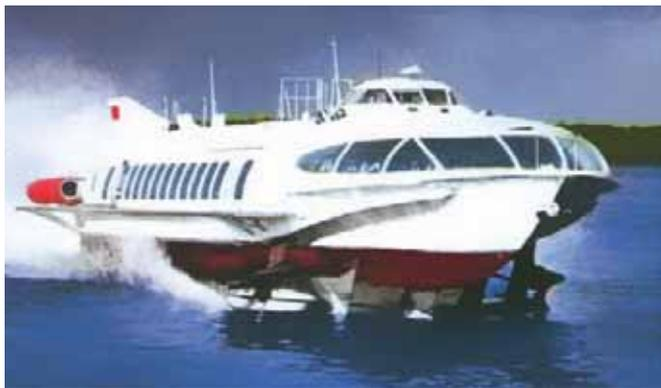
«Буревестник»: водоизмещение – 65,6 т; габариты – 43,2×7,4×3,7 м; пассажиро-местность – 150 чел.; эксл. мощность ЭУ – 2720 л.с.; скорость хода – 95 км/ч; высота волны – 1,0 м; дальность хода – 500 км
