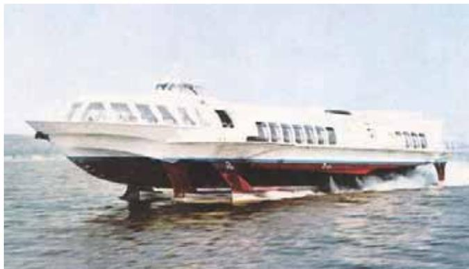
«Метеор»: водоизмещение – 53 т; габариты – 34.6×9.5 м; пассажировместимость – 128 чел.; экпл. мощность ЭУ – 2×900 л.с.; экпл. скорость хода – 65 км/ч; высота волны – 1.2 м; дальность хода – 600 км
